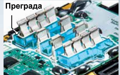
Конструкция за предотвратяване на късо съединение между клетите Специална преграда е осигурена между клетите за защита от вода и прах.
